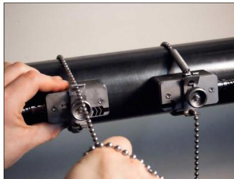
Mit Ketten und Clips angeklebte Sensoren
